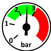
**Der maximal zulässige Druck der KIGO Klimadecken beträgt 3.0 bar.**
