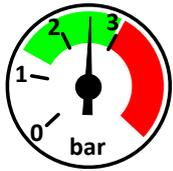
Falls die Druckprüfungen der Leitungen einen Druck über 3.0 bar verlangen, müssen die Versorgungsventile vorher unbedingt geschlossen werden.
