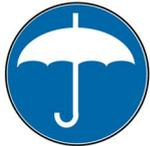
Diese spezielle Verpackung schützt sie aber nicht vor Regen und schlechter Witterung. Bei starken Niederschlägen während des Entladens und der Verteilung auf die Baustelle ist es äußerst wichtig, die Klimadecken mit einer wasserdichten Plane abzudecken. Es ist auch untersagt, die Klimadecken draußen zu lagern. Sie müssen mindestens unter einem festen Dach eingelagert und vor Witterung geschützt werden. Die durch das nicht
