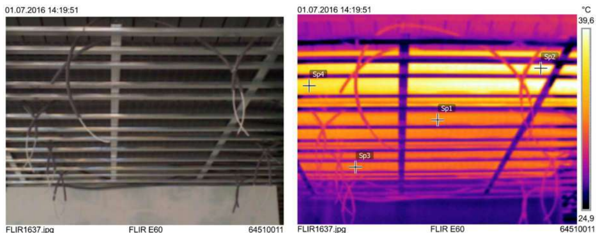
Fig. 1 – Exemple de contrôle à la caméra thermique avant la pose des plaques de faux-plafond
